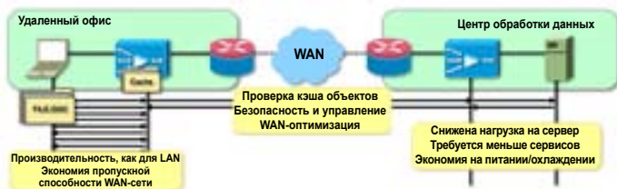
Рис. 9. Система Cisco IOS WAAS выполняет безопасное снижение нагрузки на файловые серверы в центре обработки данных.
