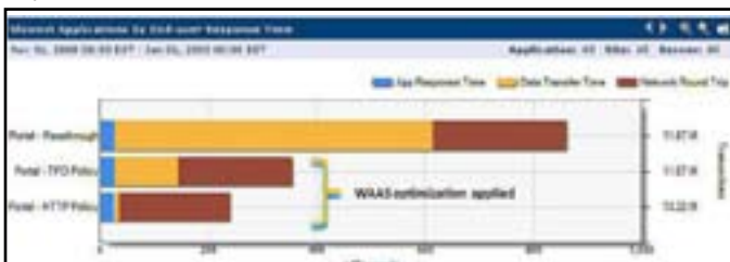
Рис. 7. Активация оптимизации работы с помощью WAAS дает существенное сокращение времени отклика для конечных пользователей
